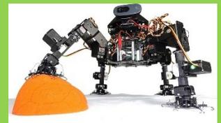
月縦孔を探査するロッククライミングロボットのプロトタイプ
