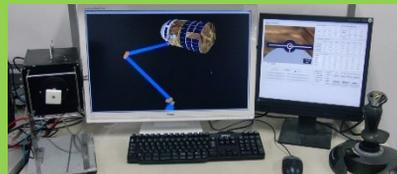
宇宙マニピュレータSSRMSによるHTV捕獲の動力学シミュレータ
