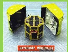
「はやぶさ2」搭載の小惑星探査ロボットMINERVA-II2
