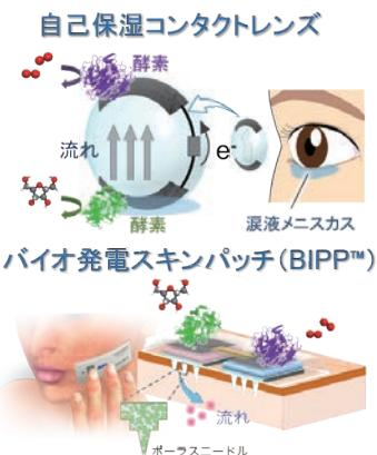
図② バイオ電池で駆動するマイクロ創流デバイス
