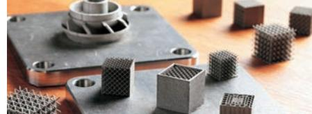
3Dプリンターにより造形したラティス構造体
