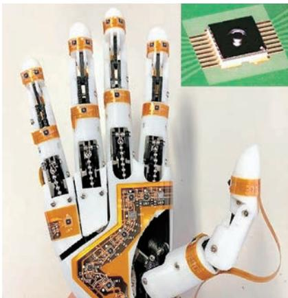
図1 ロボットハンド<sup>\*</sup>に実装した集積化触覚センサ
